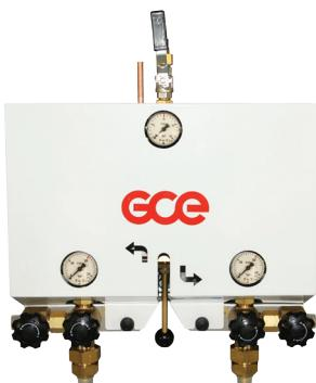
La centrale MM40 est une centrale semi automatique. Elle est conçue pour fonctionner à deux niveaux de pression entre le détendeur de service et de réserve. Avec son levier d'inversion manuelle, l'opérateur peut choisir la source en service et la source de réserve. Lorsque le côté opérationnel atteindra un niveau de pression minimal, la centrale basculera automatiquement vers la source de réserve et ceci sans aucune manipulation manuelle. Ainsi, il n'y aura aucune interruption du débit.
