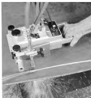
IMP do cięcia dowolnych konturów przy ręcznym prowadzeniu
