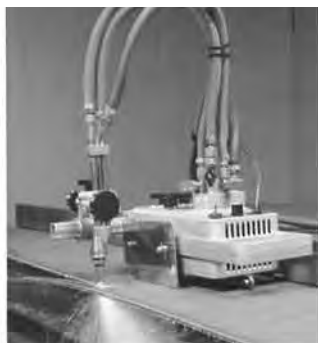
IMP do cięcia prostych odcinków przez prowadzenie przy kątowniku
