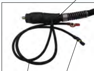
Dodatkowe osłony plastikowe na przewody wodne
