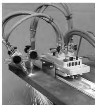
IMP do ukosowania z jednostronnie umieszczonym palnikiem
