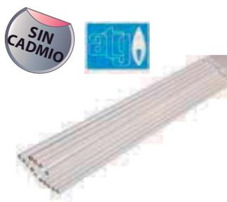
Soldadura fuerte de los cobres, bronce, metales ferrosos, aleaciones con níquel y soldadura de los aceros inoxidable, todo los metales, salvo el aluminio. Aleación cuaternaria de cobre-plata-zinc-estaño de uso universal. Sin cadmio ni plomo para soldaduras libres de componentes tóxicos.
