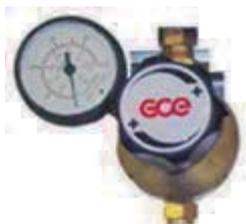
El regulador Unicontrol 700 es un regulador línea de baja presión con capacidad media de gran fiabilidad gracias a su válvula de regulación encapsulada. Se usa como segunda etapa de regulación con gases comprimidos o como regulador principal para fuentes de gas en fase líquida se suministra solo o ya integrado como punto de uso, con soporte válvula y filtro (ver UNISSET, página 206).
