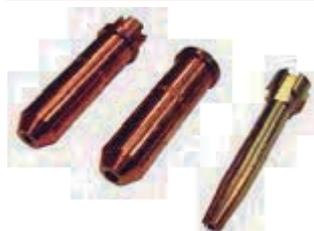
Para soplete CH70. Boquilla compacta de 58mm de Largo, con 12 canales de precalentamiento. Boquilla, idónea para desguace y demolición con su llama de precalentamiento fuerte y agresiva para un arranque rápido, hasta sobre metales oxidados, pintado o galvanizados.
