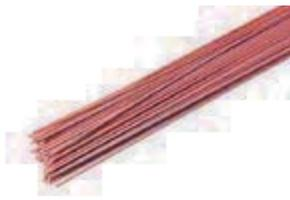
Para la soldadura de aleaciones bronce y del cobre. Soldadura de tubos de cobre y de tuberías por capilaridad. Aleación ternaria de cobre, fósforo y 5 % de plata, para la soldadura del cobre y del bronce. Soldadura con efecto capilar para distancias entre paredes de tubo de tolerancias difícil de controlar de 0,08 a 0,13mm (.003-.006"). Soldadura con efecto capilar favorecido por un rango de fusión amplio una mayor resistencia mecánica y un flujo más continuo.
