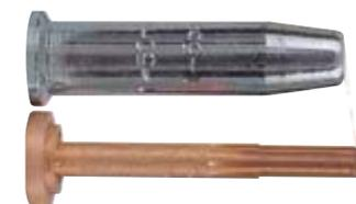
Para soplete X 11, boquilla de corte con propano compacta (44mm) y duradera, doble cromado para un mejor disipación del calor. 10 canales de precalentamiento para un corte de buena definición. Superficie del canal de corte con efecto pulido para un flujo laminar.
