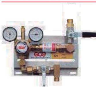
Variante de acetileno de la MM70-1 diseñada y fabricada conforme a la norma ISO 14114. El regulador y la válvula de cierre manual de acción rápida, son aprobados según norma ISO 15615 para un aguante a descomposición de acetileno entre otros ensayos.
