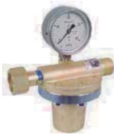
El filtro FZ11 es un conjunto de filtración de alta presión y gran caudal para gases no corrosivos como oxígeno, N<sub>2</sub>, CO<sub>2</sub>, y otros gases inertes. De gran capacidad, su flujo nominal es de 800 Nm<sup>3</sup>/h con 40 bar (600psi) de entrada y una caída de presión: máx 15 bar. Duradero, su peso de 10,6 kg, permite garantizar una gran estabilidad en el tiempo.
