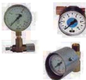
Para garantizar los valores adecuados en la entrada del soplete, se puede ajustar el indicador de control de presión en las juntas de los tubos.
