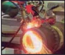
Maquina de corte portátil PCM robusta, pero de un peso ligero para cortes en ángulo recto o bisel con oxígeno - acetileno/propano, gas natural. El cuerpo de la maquina esta fabricado con una base de aleación ligera. El movimiento del soplete se realiza de forma manual mediante un engranaje, longitud estándar de 2,2mm (aproximadamente 7 pies - 8"). El conjunto estándar viene provisto de ruedas planas para su fácil movimiento en la superficie del tubo.
