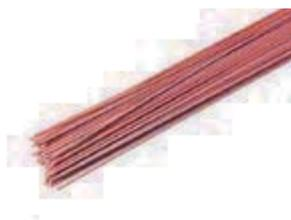
Para la soldadura de aleaciones bronce, del latón y del cobre. Soldadura de tubos de cobre y de tuberías por capilaridad. Aleación de fósforo y cobre con 15 % de plata, para la soldadura del cobre y del bronce y uniones que pueden sufrir calentamientos hasta 400°C sin sufrir cambios en sus características. Soldadura con gran ductilidad gracias al 15% de plata, excelente capilaridad para distancias entre paredes de 0,025 a 0,13mm (.001-.006”).
