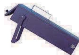
Para mantener los electrodos en un recinto seco y caliente, hasta el momento de usarlos. Disponibles en 110 V y 240 V, ambos funcionan con alimentación AC y DC. Capacidad 7,3 kg, Longitud máxima de los electrodos 450 mm, valores nominales 110 °C, 150 W.
