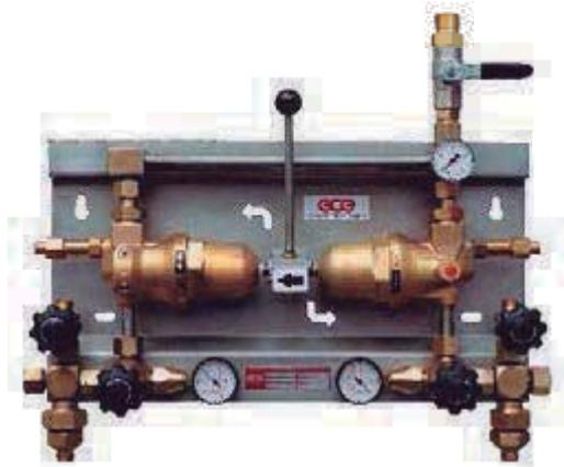
El panel de regulación y cambio semiautomático MS400 regula la presión de los gases comprimidos hasta 300 bar (4000 psi) a una presión de línea de 18 - 20 bar (275Psi) o 36- 40 bar (550Psi).
