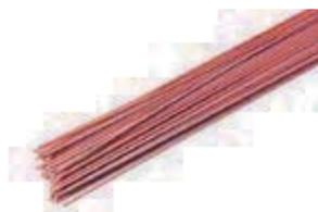
Para la soldadura de aleaciones de cobre. Soldadura de tubos de cobre y de tuberías. Aleación de cobre con 7% de fósforo con bajo punto de fusión para la soldadura del cobre sin usar desoxidantes.
