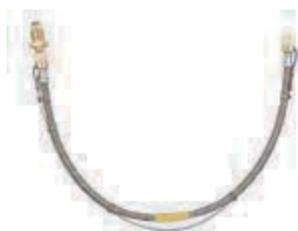
Flexibles de alta presión con alma de PTFE y externo de malla de acero inoxidable. Conexión de bronce prensada G3/8H a usar con la check MM3922 y 1/4NPT hembra para enroscar conectores estándares.
