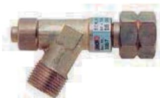
La válvula SBS se monta a la salida del regulador de propano. Corta la alimentación de propano/butano en caso de rotura o seccionamiento de la manguera. Se rearma oprimiendo el botón de reactivación. De diseño Alemán, robusto y fiable, esta aprobada por el organismo certificador alemán DVGW Registro N° 92.02e868.
