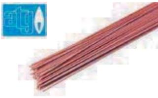
Para la soldadura de aleaciones bronce y del cobre. Soldadura de tubos de cobre y de tuberías por capilaridad. Aleación cuaternaria de cobre-fósforo-plata-níquel, con 6% de plata certificado ATG para la soldadura de canalizaciones de gas en baja presión.
