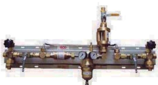
Unidad de regulación doble de cambio manual para aplicaciones donde grandes caudales de acetileno son necesarios. Diseñado y fabricado de conformidad con nueva norma vigente para redes centralizadas de acetileno, la ISO 14 114. Los bloques de entrada en X tienen un puerto auxiliar para recibir un manifold de extensión e aumentar el número de cilindro/paquetes. Están equipados válvulas anti-retorno y filtros de gran caudal, válvulas de purga, despiche o para conectar un circuito de inertización.
