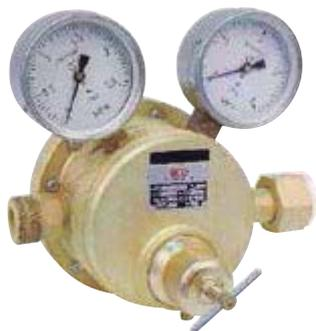
Los reguladores VPK 631 y VPKU 151 son reguladores de simple etapa pilotados, de alta presión y caudales muy grandes. La regulación de la presión se hace mediante un regulador integrado en el cuerpo del regulador lo que permite a estas presiones y caudales, tener un regulador industrial fuerte, duradero y robusto. Los reguladores VPK 631 y VPKU 151 tienen un cuerpo de bronce macizo (peso: 21 kg) con aleta de intercambio de calor para compensar los enfriamientos generados a la descompresión.
