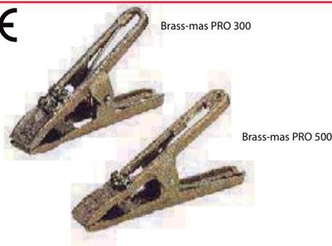
Pinzas de masa profesional de bronce con diseño moderno y optimizado. Fijación práctica del cable cerca de la superficie de contacto para una alta conductividad y una menor caída de carga posible. Ideal para uso industrial, soldaduras profesionales de espesores medianos a grandes.
