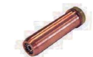
Para el soplete RAFALE, boquilla maciza de 67.5 mm de largo, con 12 canales de precalentamiento, para corte de espesores de hasta 1 metro.
