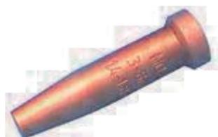
Para soplete X 11. Boquilla compacta (44 mm) de cobre telurio, duradera con 6 canales de precalentamiento. Superficie del canal de corte con efecto pulido para un flujo laminar.
