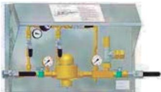
El Panel de regulación TDS esta compuesto de un regulador de Dome pilotado por un regulador Unicontrol. Está provisto de válvula de seguridad y válvulas de cierre a la entrada y la salida. Esta montado sobre un soporte de acero zincado, previsto para protegerlo de la intemperies.
