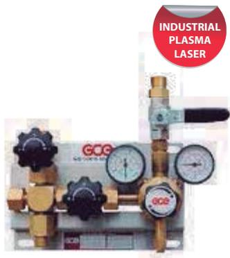
Unidad de regulación simple para gases comprimidos hasta 300 bar (4000 Psi) y caudales medios (50m<sup>3</sup>/h). Unidad de regulación montada sobre un soporte de acero inoxidable, equipada con válvula anti-retorno, filtro, válvula de purga o despiche, para liberar presión cuando se desmonta la manguera del cilindro/baterías de cilindros y una segunda entrada para instalar un manifold de extensión.
