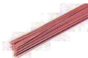
Para la soldadura de aleaciones de cobre. Soldadura de tubos de cobre y de tuberías por capilaridad. Aleación ternaria de cobre, fósforo y 2 % de plata, para la soldadura de aleaciones de cobre. Soldadura idónea con distancias entre paredes de tubo de 0,05 a 0,13mm (.002-.005").
