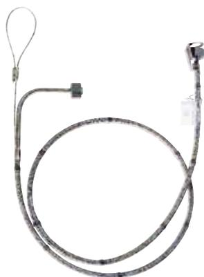
Flexibles de alta presión con alma de PTFE o ETFE para helio e hidrógeno y externo de malla de acero inoxidable. Conexión de acero inoxidable prensada según estándar de conexión de cilindro.
