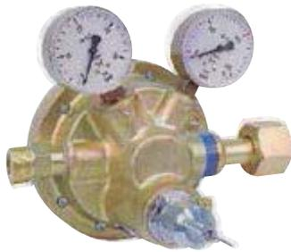
Reguladores VPK 251 y VPKU 91 son reguladores de simple etapa pilotados de alta presión y gran caudal. La regulación de la Presión de línea se hace mediante un regulador, integrado en el cuerpo del regulador, lo que permite a estas presiones y caudales, tener un regulador industrial duradero, robusto y bastante compacto. (peso:9.4 kg).
