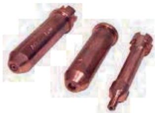
Para soplete CH70. Boquilla compacta de 58mm de largo, llama de precalentamiento con efecto de cortina para proteger la pureza del oxígeno y brindar un corte de excelente definición. Su bajo consumo de acetileno permite limitar las deformaciones sobre chapas delgadas y permite cortes hasta 300 mm (12"). Boquilla en 2 piezas para facilitar su limpieza, mantener una buena definición de la llama para un corte perfecto.
