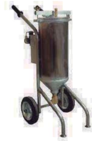
El oxicorte con polvo de hierro permite el desguace y corte de aceros militares, fuertemente aliados, cobre y aleación de cobre, acero con níquel, aluminio y aleación de aluminio y los hierros fundidos que se resisten al oxicorte tradicional.
