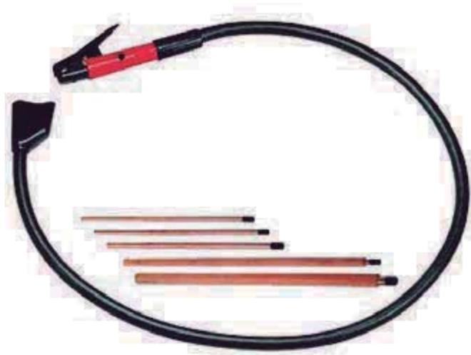
Antorchas Arco Aire y electrodos de carbono. El proceso Arco Aire corte elimina por fusión metal, no químicamente como en oxicorte. El ranurado o corte se produce cuando el intenso calor del arco entre el electrodo de carbono y la pieza funde el metal y al mismo tiempo, el aire pasa a través del arco con la suficiente velocidad para soplar el material fundido.
