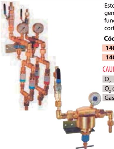
Estos puestos de trabajo triple se basan en el regulador S200 para oxígeno de corte. El gas combustible y el oxígeno de calentamiento se suministran mediante reguladores S200, ambos con los anti retroceso de llama de tres funciones FR91 montados en paralelo para el abastecimiento de grandes máquinas de oxicorte (20 sopletes FIT+ cortando a la vez 300mm (12").
