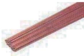
Para soldadura autógena de aceros suaves. Varilla recubierta de cobre para protegerla de la oxidación y una soldadura muy suave, sin ebullición ni escorias. A usar con oxígeno-acetileno (no oxi-propano), ajustando una llama neutra o ligeramente oxidante.
