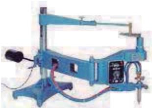
Esta máquina de utilización sencilla puede reproducir figuras desde una plantilla de acero reutilizable. Dicha plantilla es trazada por un rodillo magnético con un sistema de velocidad variable SCR que proporciona máxima estabilidad. La plantilla es totalmente ajustable al brazo. Las plantillas para trazado interno y externo se reproducen de manera sencilla.
