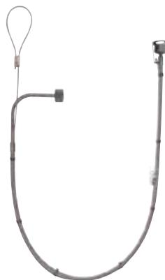
Flexibles de alta presión con alma de PTFE o ETFE para helio y hidrógeno y externo de malla de acero inoxidable. Conexión de acero inoxidable prensada según estándar de conexión de cilindro. Para uso con presiones de servicio de 200 bar (3000 psi).
